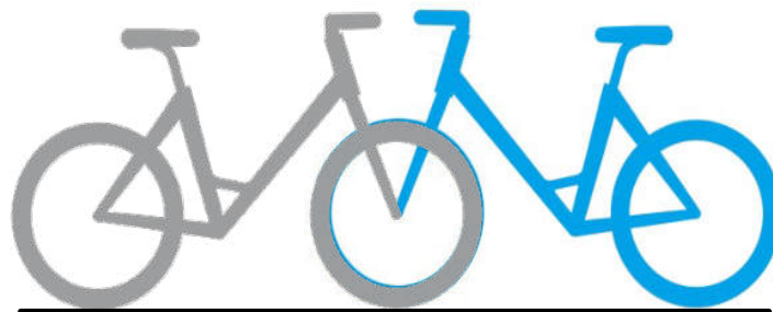
Figure 7 : Principe de disposition des vélos avec recouvrement des roues avant
